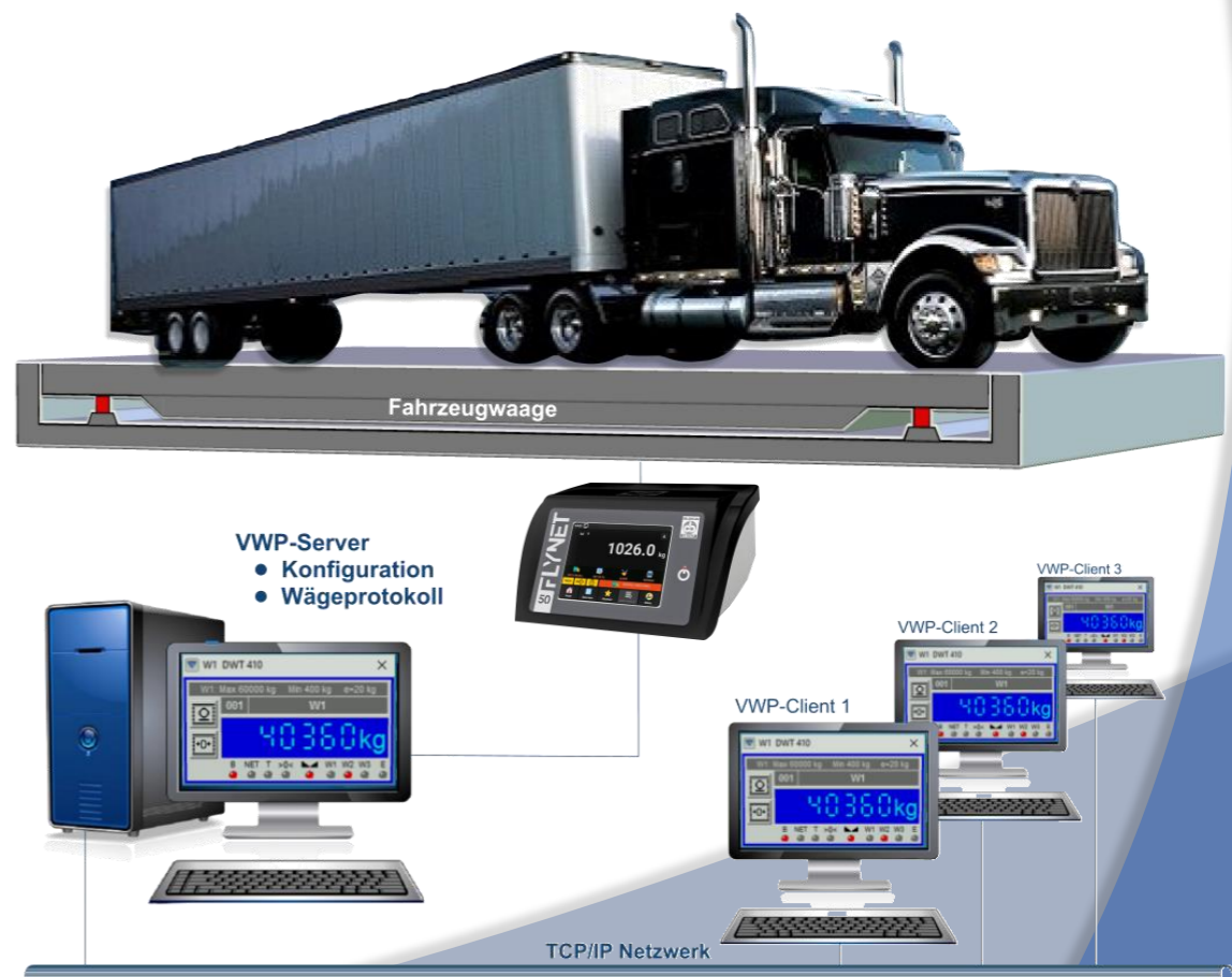
Blockschema einer Server/Client-Installation
